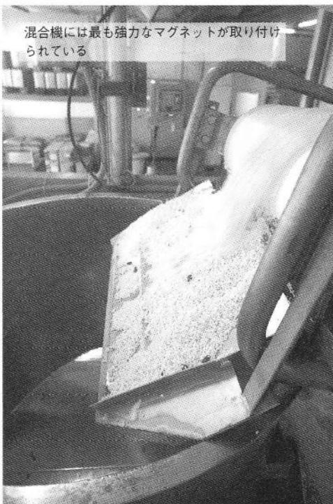
混合機には最も強力なマグネットが取り付けられている
